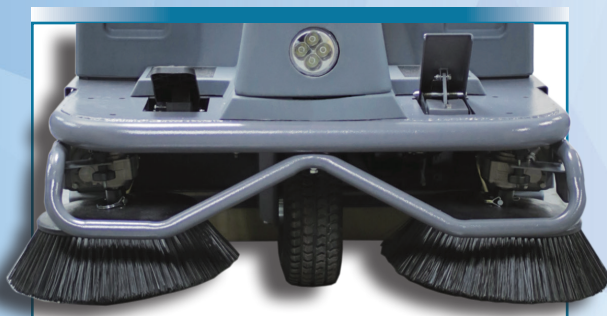
STANDAARD EEN LINKER EN RECHTER ZIJBEZEM MET BESCHERMING TEGEN AANRIJDEN
